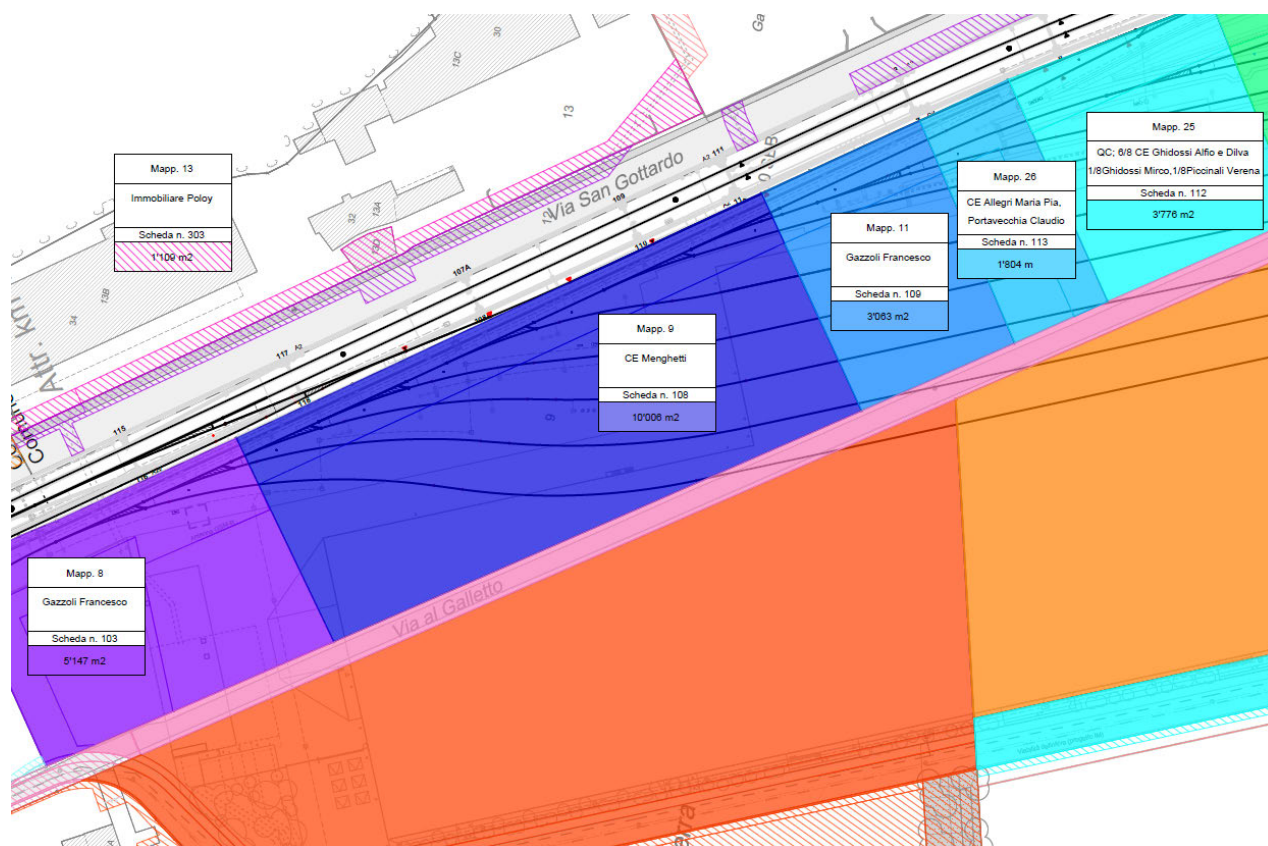
Figura 19: Estratto di un piano delle espropriazioni (esempio FFS - Nuovo stabilimento industriale ferroviario NSIF Castione, 1.3.2023)
